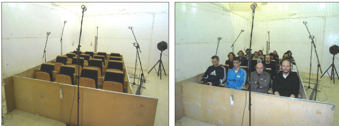
Imágenes 5 y 6 Ensayo de las butacas sin y con ocupante
