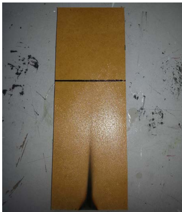
Aspecto de la muestra tras el ensayo de inflamabilidad según UNE-EN ISO 11925-2:2011 (aplicado en borde)
