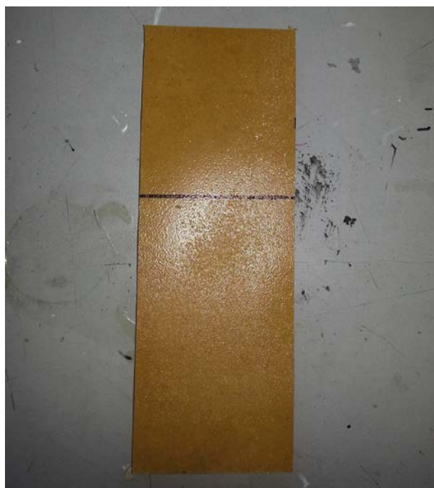
Aspecto de la muestra antes del ensayo de inflamabilidad según UNE-EN ISO 11925-2:2011 (aplicado en borde)
