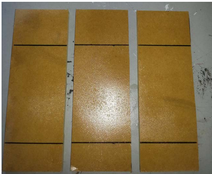
Aspecto de la muestra antes del ensayo de inflamabilidad según UNE-EN ISO 11925-2:2011 (aplicado en superficie)
