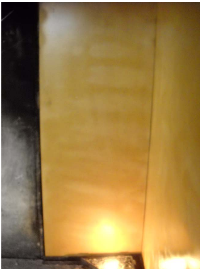
Aspecto de la muestra antes del ensayo de SBI (ala corta) según UNE-EN 13823:2012
